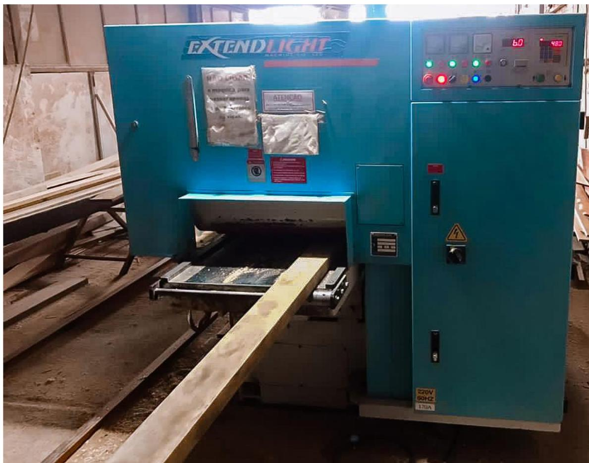
Trabalhamos com o Pinus Taeda seco em estufa, com umidade controlada de 10% a 14%. Qualidade validada por consultores, com destaque para o acabamento, madeira aparelhada em máquina helicoidal, rara no Brasil, o que garante uma aparelhagem mais uniforme com veios e nós bem destacados e acabamento liso, sem dentes e marcas característicos das facas de aparelhagem comuns.
